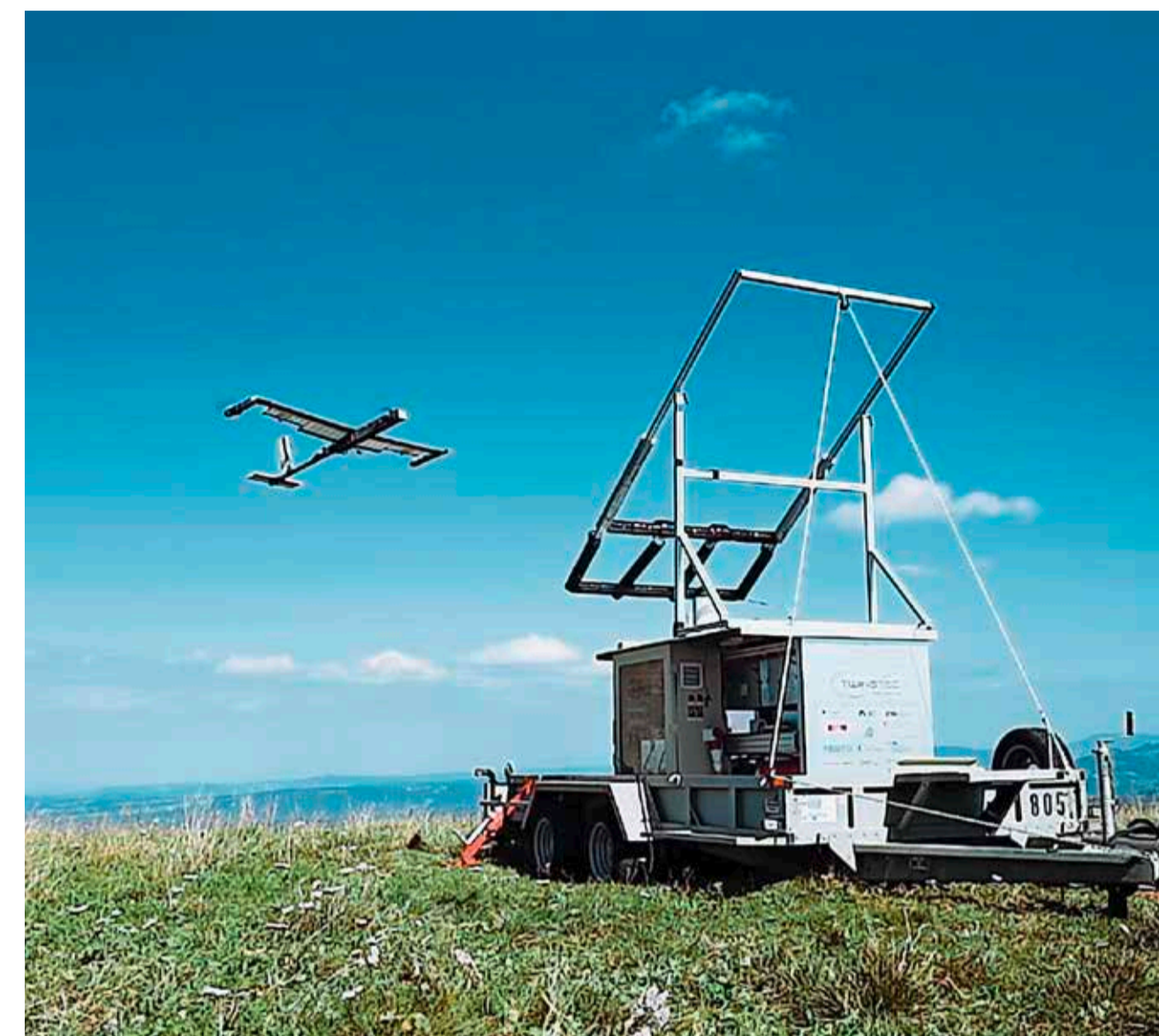
Das Start-up Twingtec testet auf dem Chasseral seine TT100, das weltweit erste mobile Windenergiesystem.. Bild: TwingTec
